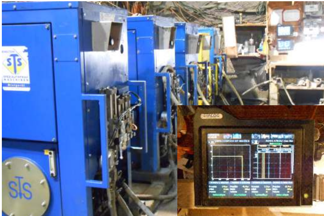
centrale d'injection en caverne avec système Dialog pour GIN
