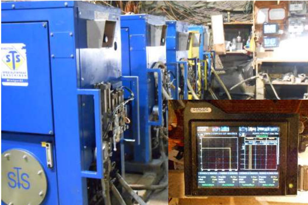
Injektionszentrale mit DIALOG GIN-Bildschirm
